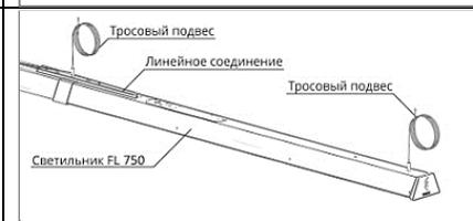
Светильник может быть подвешен при помощи АКС002 "тросовый подвес" (1 шт. в составе комплектации). В случае соединения светильников линейным соединением тросовый подвес устанавливается в резьбовую часть линейного соединения.
